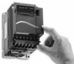
Демонтаж дополнительной платы
